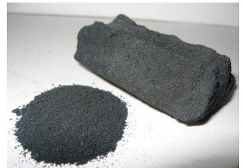
**Ilustración 2.8** El carbón activado es un derivado del carbón que ha sido tratado de forma tal, que se convierte en un material extremadamente poroso.
